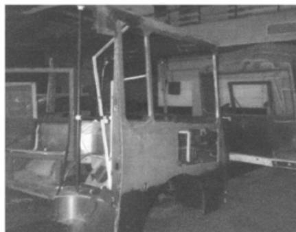
Рис. 1. Передняя и задняя секции кузова автобуса
