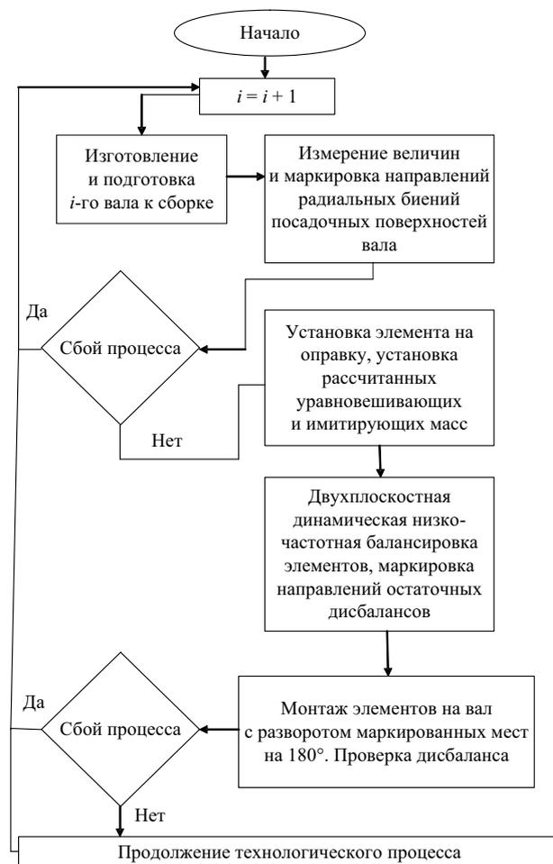
Рис. 3. Алгоритм управления технологическим процессом сборки валопровода
