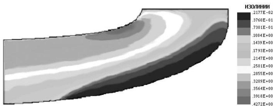
Рис. 1. Изолинии чисел Маха скорости потока в диффузоре
