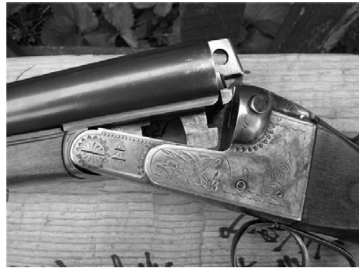
Рис. 1. Ружье с запиранием на два подствольных крюка и болт Гринера
