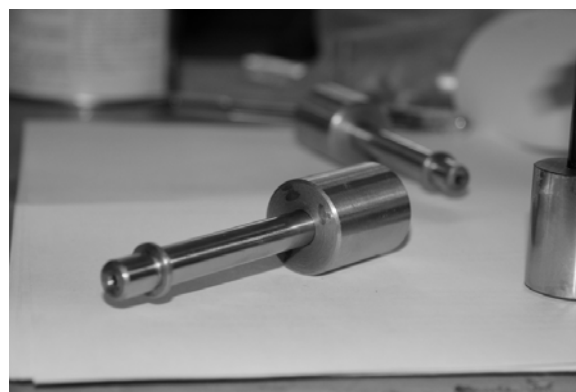
Рис. 2. Пример соединения с натягом для экспериментального исследования
