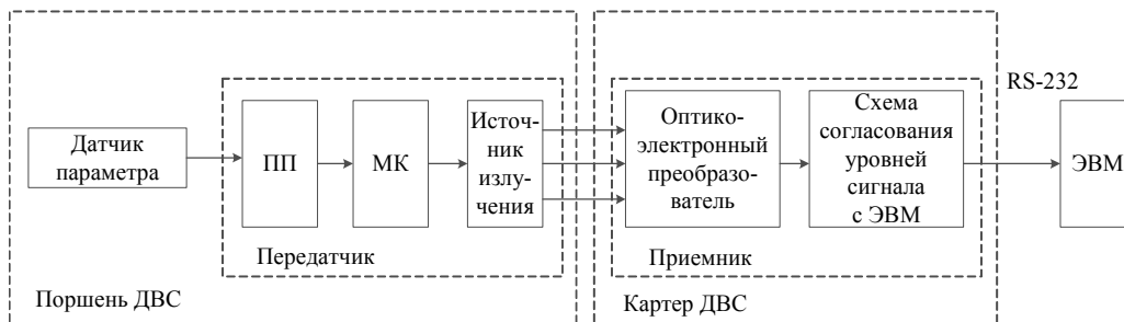
Рис. 1. Структурная схема микропроцессорной системы измерения температуры поршня ДВС
