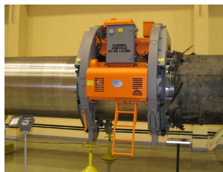
Рис. 1. Автоматизированная машина предварительной очистки трубопроводов
