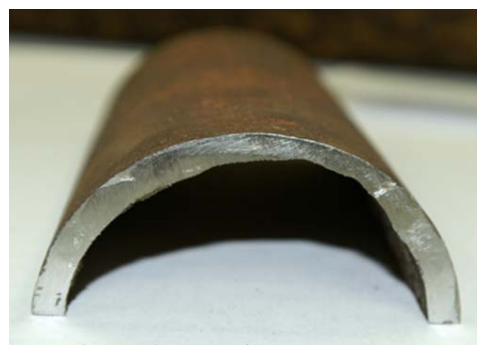
Рис. 1. Протир насосно-компрессорной трубы вследствие трения о муфту (а) и трения о штангу (б)
