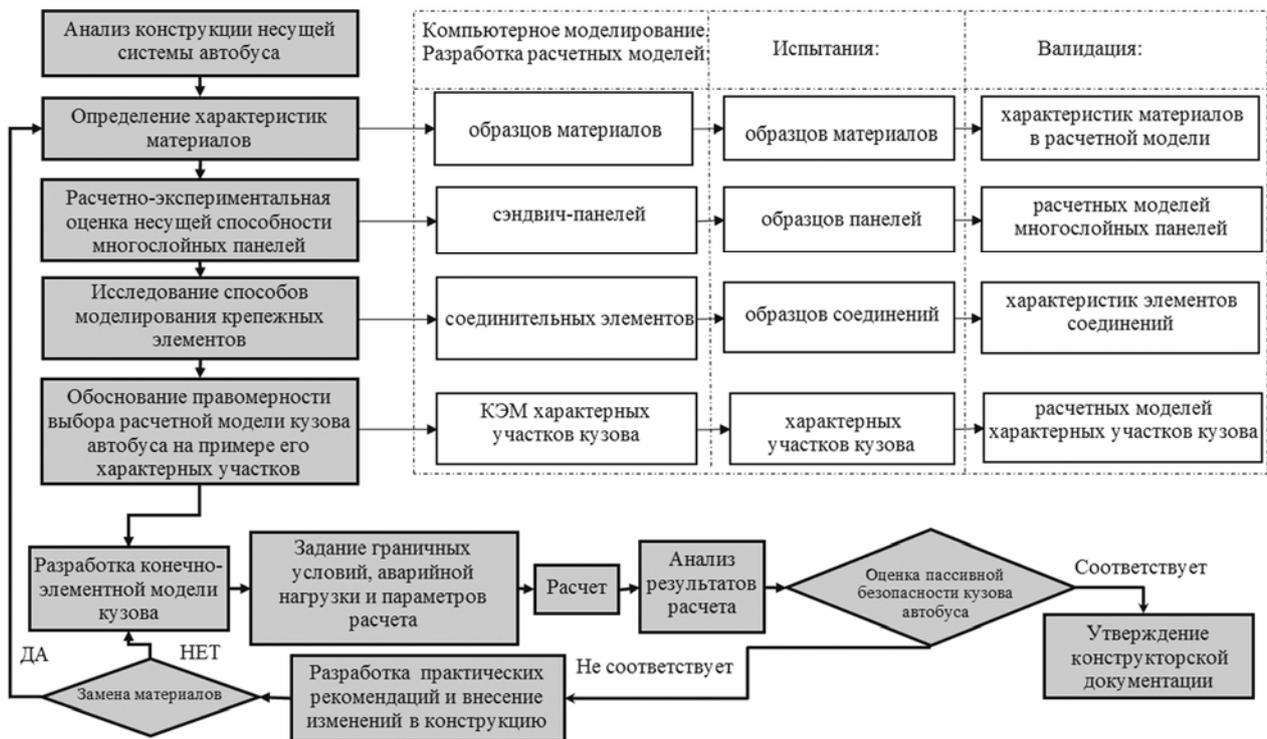
Рис. 1. Структурная схема методики расчетно-экспериментальной оценки пассивной безопасности кузовов из многослойных панелей автобусов
