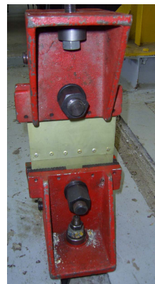
Рис. 7. Фрагмент испытания заклепочного соединения
