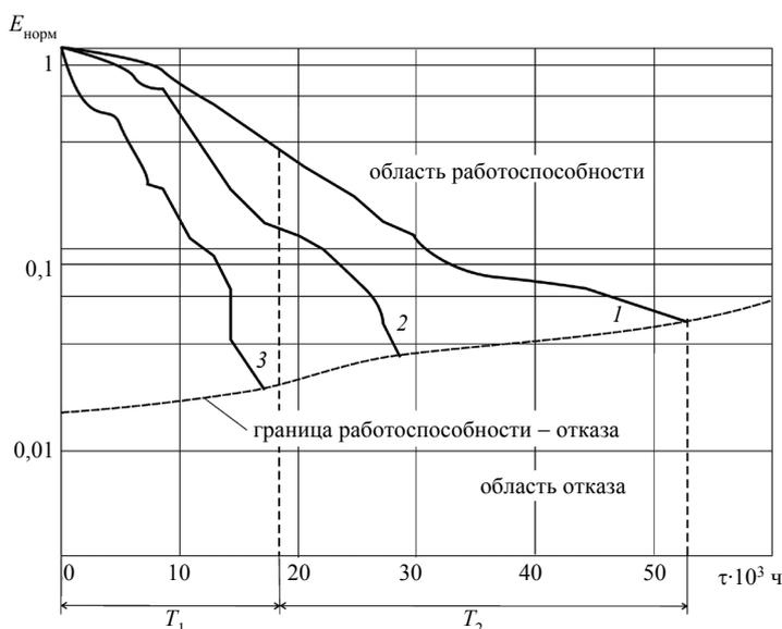
Рис. 2. Изменение нормированного  $E$  в процессе старения изоляции ЭМ (асинхронный двигатель серии 4А, мощность 1,5 кВт):  $T_1$  – период нормальной эксплуатации;  $T_2$  – период старения (для нормального режима); режимы эксплуатации: 1 – нормальный; 2 – повышенная влажность и температура; 3 – резкие колебания температуры, повышенная вибрация и влажность
