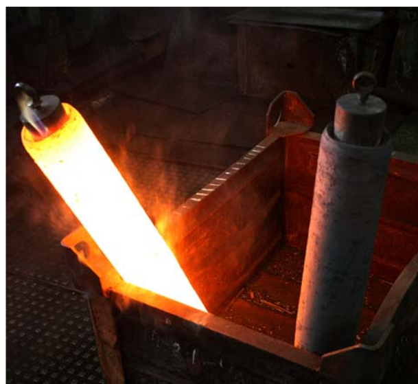
Пример деталей, изготовленных с применением 2-валкового стана поперечно-винтовой прокатки для получения глухого отверстия с дном
