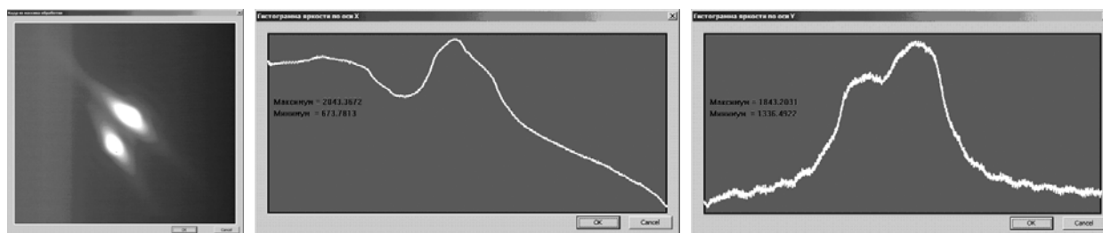
Рис. 2. Кадр изображения и гистограммы яркости при ошибочной ситуации в виде двух световых пятен
