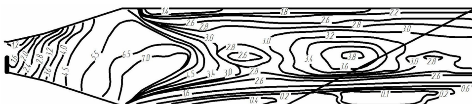
Рис. 4. Распределение чисел Маха в продольном сечении соплового блока
