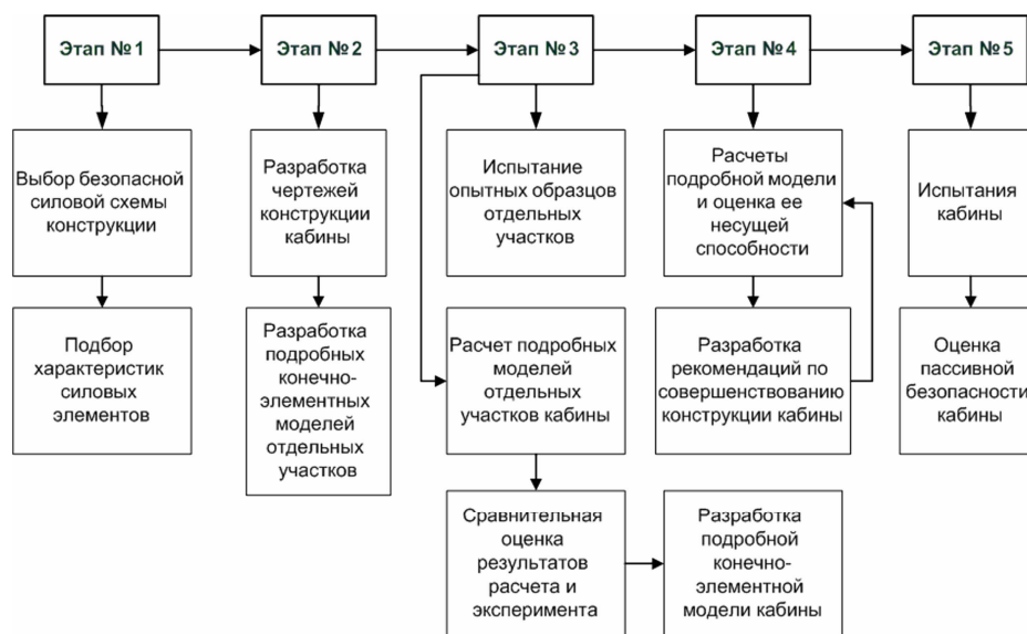
Рис. 1. Блок-схема методики выбора безопасной конструкции кабины
