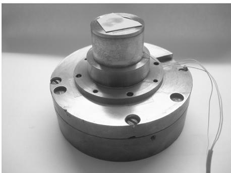
Рис. 2. Внешний вид установки для виброобработки подложек с нанесенным жидким концентратом наночастиц
