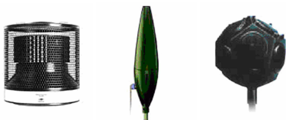
Рис. 1. Эталонные источники звукового давления фирмы Brüel&Kjaer
