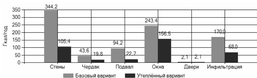
Рис. 4. Структура тепловых потерь
