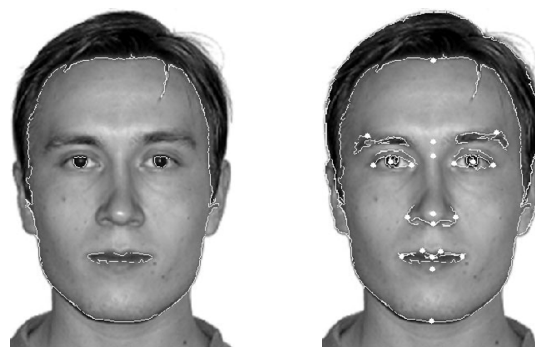
Рис. 3. Результаты распознавания характерных элементов: а – выделенные области лица, зрачков и губ; б – сетка антропометрических точек
