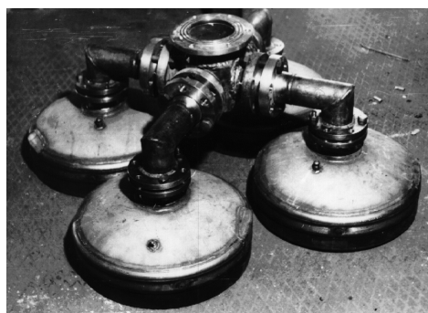
Рис. 4. Фотография узла распыла горячей воды на дегазацию промышленного дегазатора [5, 6, 12]
