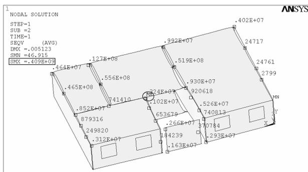
Рис. 7. Эквивалентные напряжения в стыках при растяжении (линейный расчет)
