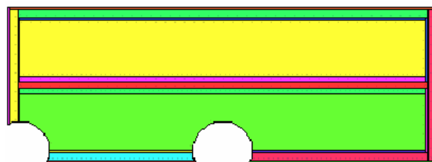
Рис. 6. Схема образования карстовых воронок под фундаментом
