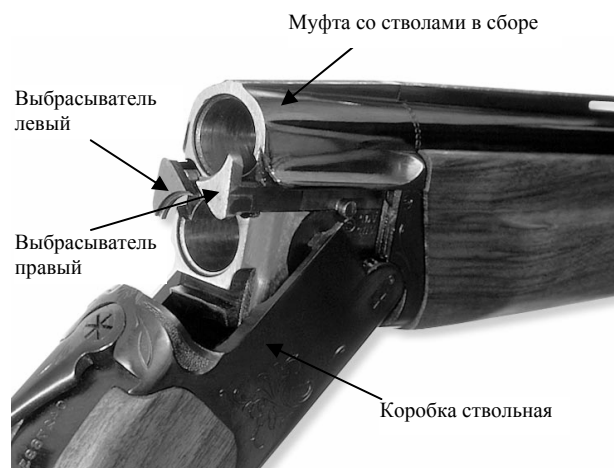
Рис. 2. Характерные места МР-27М, подвергающиеся пригонке
