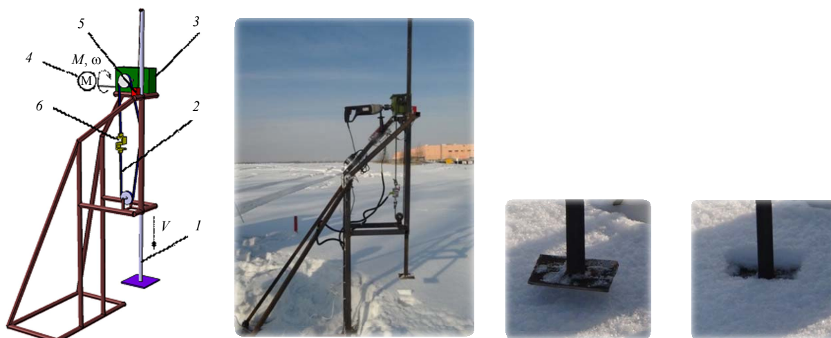
Рис. 1. Экспериментальная установка для определения коэффициента жесткости снега: 1 – шток со штампом; 2 – цепная передача; 3 – червячный редуктор; 4 – электродвигатель; 5 – датчик перемещений; 6 – динамометр универсальный
