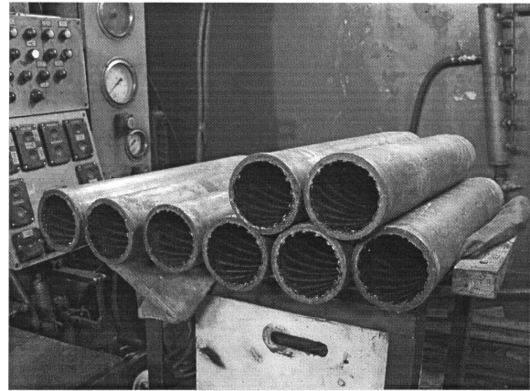
Рис. 3. Вид внутренних спиральных канавок на корпусах после первого редуцирования на пуансоне
