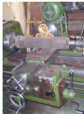
Рис. 2. Специальное приспособление с планетарной головкой и торцевыми шлифовальными кругами
