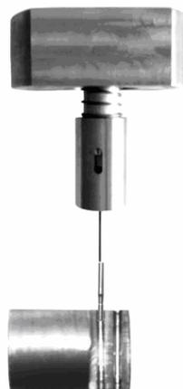
Рис. 1. Компоновка технологической наладки дорнования
