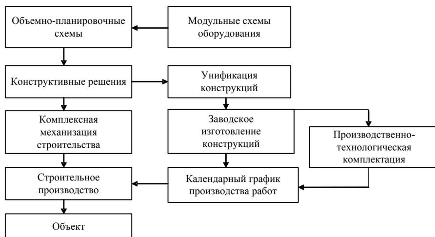
Схема элементов индустриально-строительной системы
