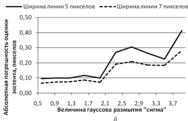
Рис. 3. Величина абсолютной ошибки оценки экстенда малоразмерных линий в зависимости от степени размытия: а – равномерное размытие; б – гауссово размытие
