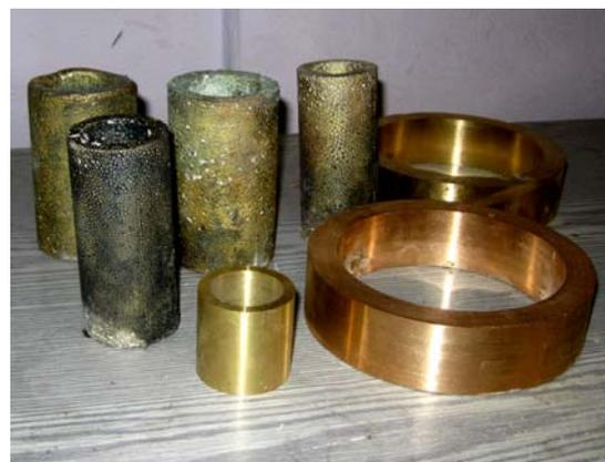
Рис. 2. Отливки и предварительно обработанные заготовки из оловянистой бронзы, объемно легированные графитом
