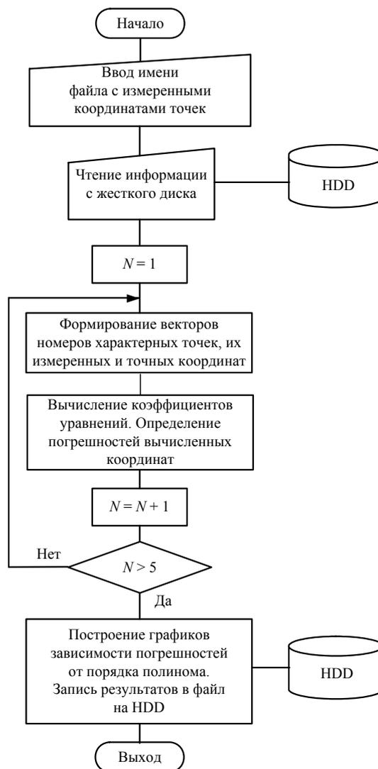
Рис. 3. Блок-схема алгоритма вычисления характеристик камер
