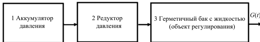
Рис. 2. Структурная схема системы подачи жидкости
