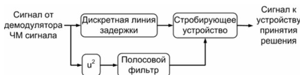
Рис. 2. Схема алгоритма тактовой синхронизации
