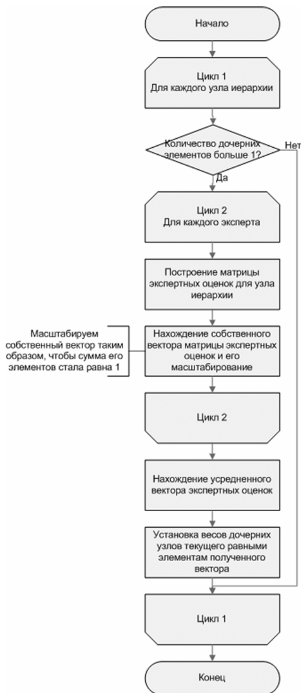
Рис. 2. Блок-схема «Получение средних весов w_i, i = \overline{1..n} , по экспертным оценкам»
