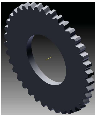
Рис. 5. Коническое колесо с неэвольвентным профилем зубьев
