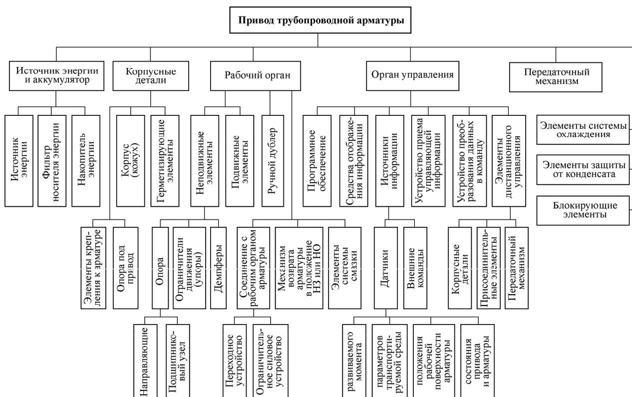
Рис. 2. Структурная модель привода трубопроводной арматуры: НЗ – нормально закрытая; НО – нормально открытая
