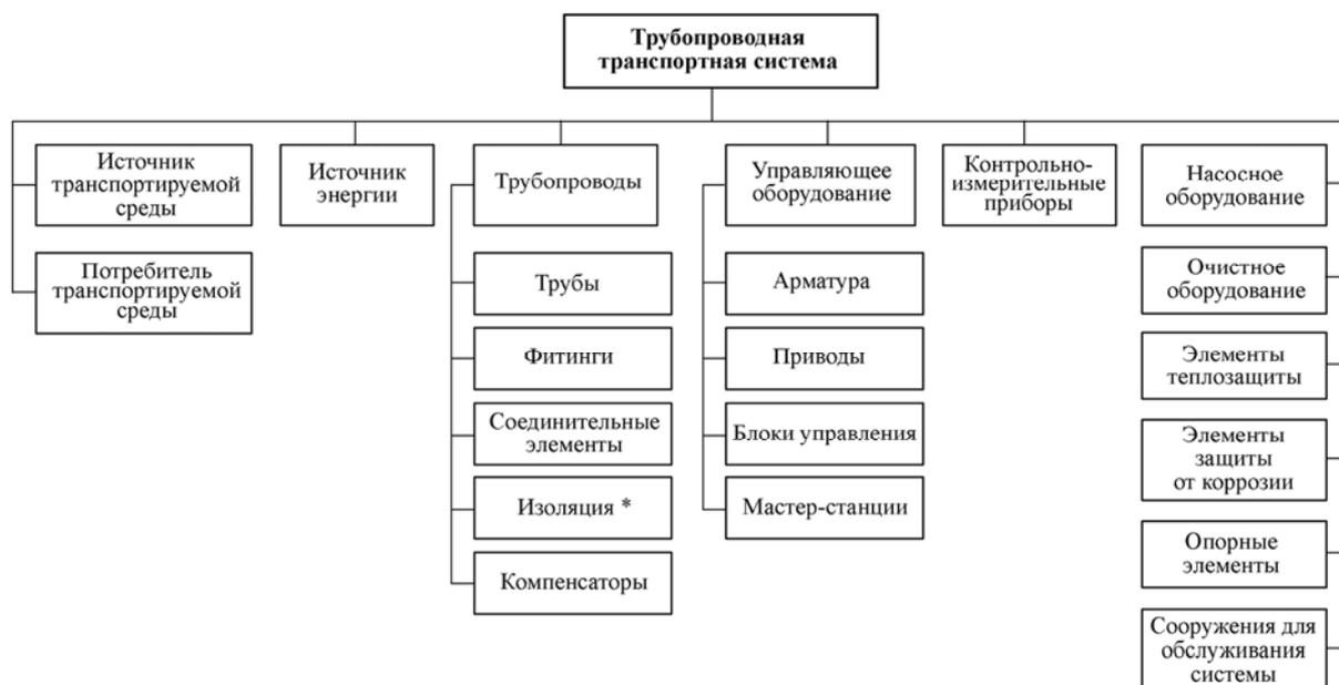
Рис. 1. Структурная модель трубопроводной транспортной системы:
