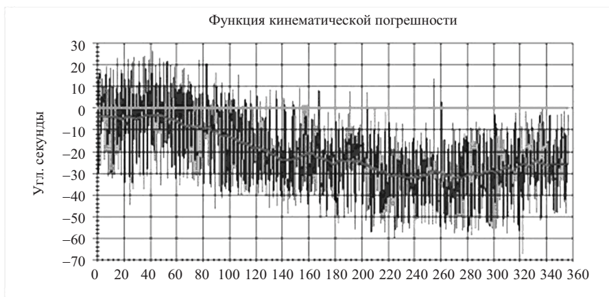
Рис. 4. Кинематическая погрешность передачи вида K-H-V
