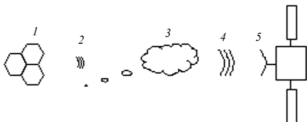
Рис. 2. Система передачи информации: 1 – уголкового отражателя с модулятором; 2 – отраженный сигнал; 3 – среда передачи сигнала; 4 – несущее излучение; 5 – аппарат, собирающий информацию
