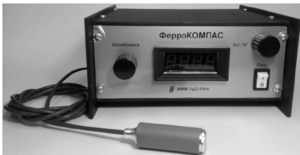
Рис. 7. Прибор «ФерроКОМПАС» – измеритель магнитной проницаемости аустенитных сталей
