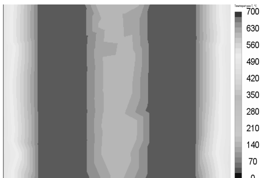
Рис. 10. График распределения тепла в модели ELCUT с двумя нагревательными стержнями в плоскости № 10
