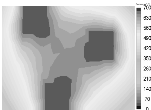
Рис. 12. График распределения тепла в модели ELCUT с тремя нагревательными стержнями в плоскости № 15
