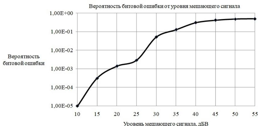
Рис. 7. График возрастания вероятности ошибки приема бита от увеличения уровня сигнала, передаваемого с помощью стороннего спутника
