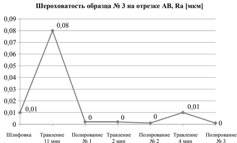
*Рис. 9. Изменение параметра шероховатости образца № 3 в зоне отрезка AB*
