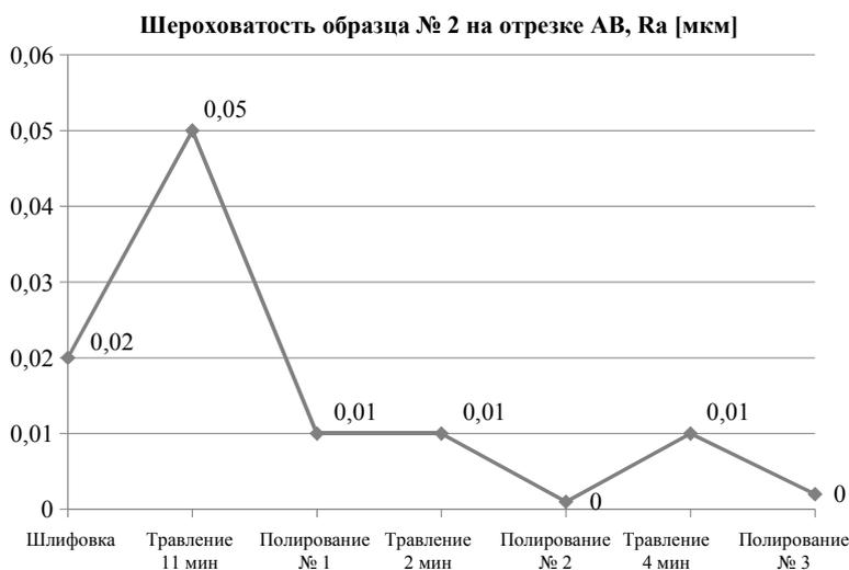
Рис. 7. Изменение параметра шероховатости образца № 2 в зоне отрезка АВ
