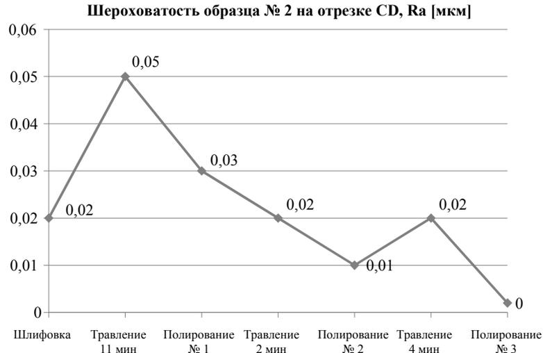
*Рис. 8. Изменение параметра шероховатости образца № 2 в зоне отрезка CD*
