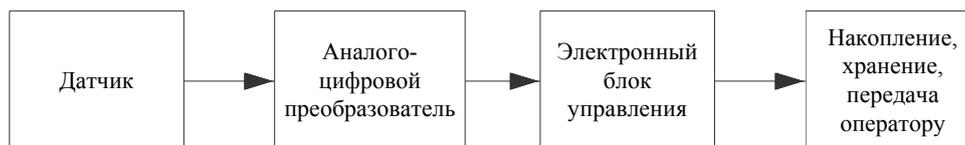
Рис. 2. Блочная схема контроля датчика температуры двигателя
