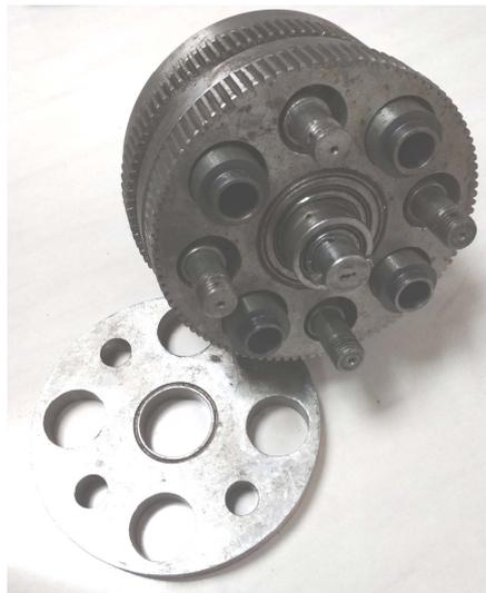
Рис. 2. Экспериментальный роликовый механизм передачи момента
