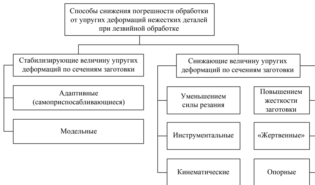
Рис. 2. Классификация способов снижения погрешности обработки от упругих деформаций нежестких деталей при лезвийной обработке
