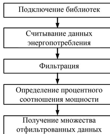
Рис. 2. Функциональная блок-схема фильтрации
