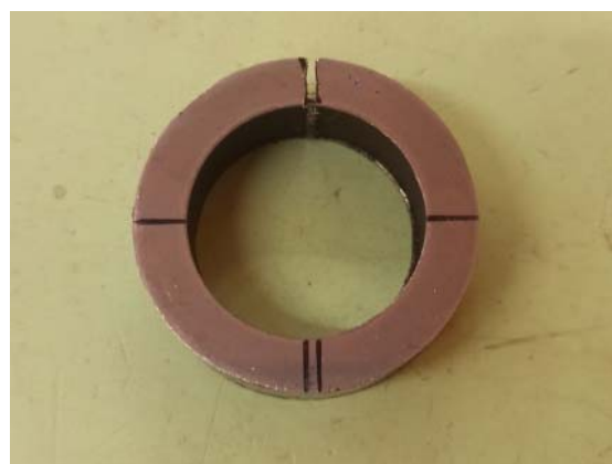
Рис. 5. Схема измерения диаметра (а) и вид кольцевого образца (b)
