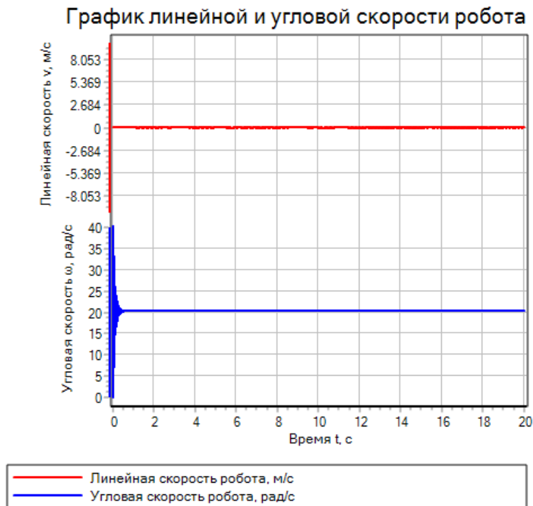
Рис. 7. Графики линейной и угловой скоростей трехколесного робота (разворот на месте, U_l = 40 В, U_r = -40 В, U_c = 40 В, \theta = 90^\circ )
