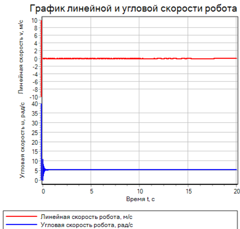
Рис. 8. Графики линейной и угловой скоростей трехколесного робота (разворот на месте с тормозящим опорным колесом, U_l = 40 В, U_r = -40 В, U_c = 40 В, \theta = 270^\circ )
