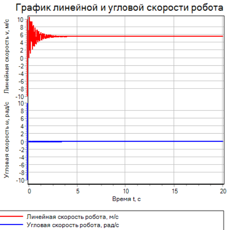
Рис. 5. Графики линейной и угловой скоростей трехколесного робота (движение по прямой, U_l = 40 В, U_r = 40 В, U_c = 40 В, \theta = 0^\circ )
