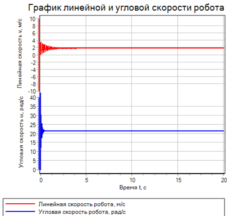
Рис. 9. Графики линейной и угловой скоростей трехколесного робота (разворот по малой дуге, U_l = 40 В, U_r = -40 В, U_c = 40 В, \theta = 0^\circ )
