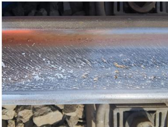
Рис. 1. Контактно-усталостные трещины поверхности катания рельсов, на которых начались выкрашивания
