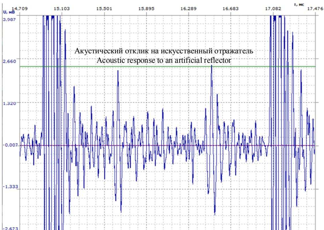
Рис. 6. Эхограмма трубы с искусственным отражателем на 8-м отражении (звено 1)
